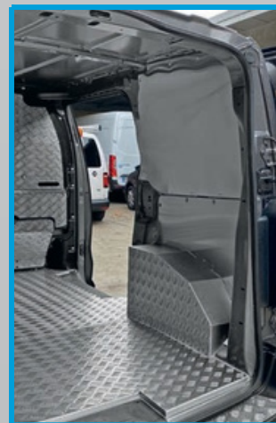
Plataforma compuesta abedul 9 mm + aluminio damero, panel en aluminio, revestimiento del separador de carga en aluminio damero, protector de rueda en acero aluminado y aluminio damero.
