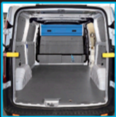
Ford Custom: el equipamiento suspendido deja libre toda la zona de carga.
