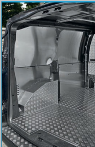
Plataforma compuesta abedul 9 mm + aluminio damero, panel en aluminio, revestimiento del separador de carga en aluminio damero, protector de rueda en acero aluminado y aluminio damero.
