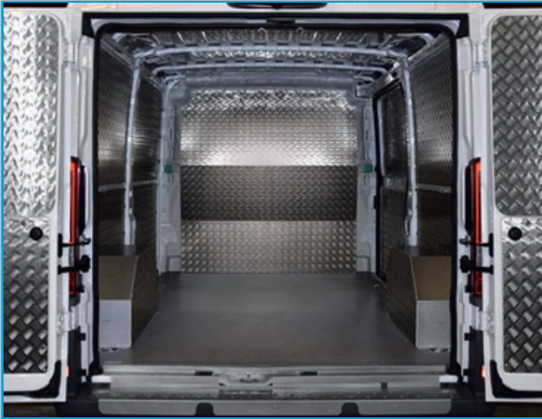
Suelo en multicapa de abedul marmoleado, panel y protector de separador de carga en aluminio damero, protector de rueda en acero aluminado y aluminio damero
