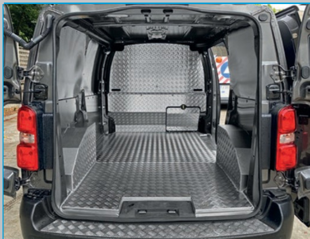
Plataforma compuesta abedul 9 mm + aluminio damero, panel en aluminio, revestimiento del separador de carga en aluminio damero, protector de rueda en acero aluminado y aluminio damero.
