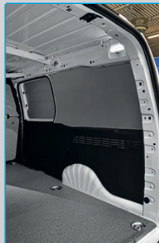
Plataforma y revestimiento del separador de carga en multicapa de abedul marmoleado, panel en chapa barnizada gris
