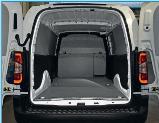
Plataforma y revestimiento del separador de carga en multicapa de abedul marmoleado, panel en chapa barnizada gris
