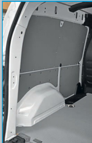
Suelo en madera contrachapada Recubierto de goma, Paneles electrolgalvanizados y pintados gris
