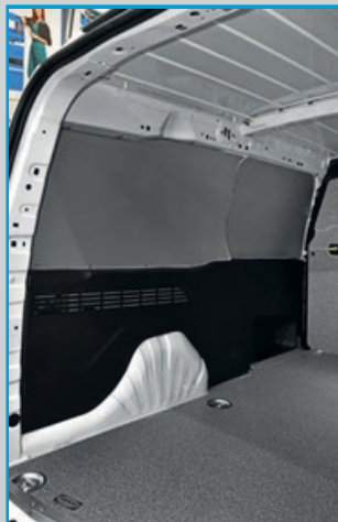
Plataforma y revestimiento del separador de carga en multicapa de abedul marmoleado, panel en chapa barnizada gris
