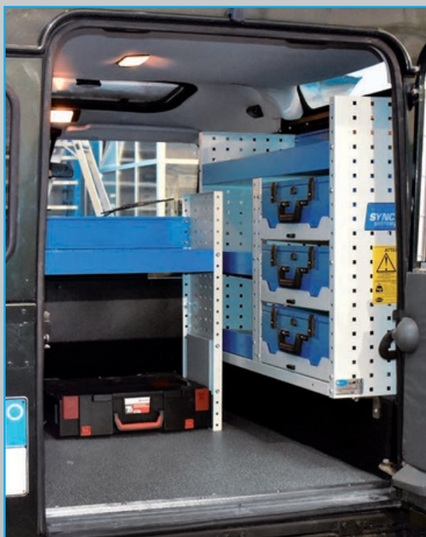
Equipamiento interno con estanterías y cajoneras montado en Land Rover Defender.
