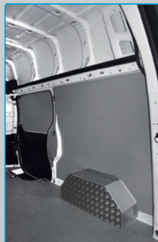
Suelo en multicapa de abedul marmoleado, panel en chapa barnizada gris, protector de rueda en acero aluminado y damero
