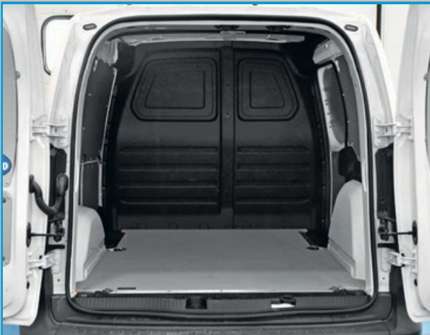
Suelo en madera contrachapada Recubierto de goma, Paneles electrolgalvanizados y pintados gris
