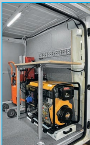
Un laboratorio móvil equipado con aire comprimido, corriente eléctrica y varios equipos del cliente montados por el personal Syncro System.
