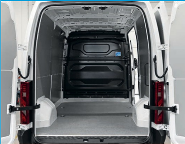
Suelo en multicapa de abedul marmoleado, panel en chapa barnizada gris
