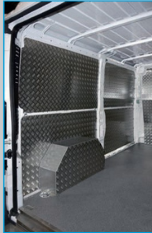
Suelo en multicapa de abedul marmoleado, panel y protector de separador de carga en aluminio damero, protector de rueda en acero aluminado y aluminio damero
