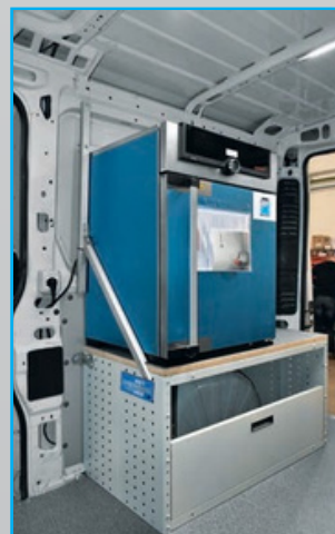
Un laboratorio móvil equipado con aire comprimido, corriente eléctrica y varios equipos del cliente montados por el personal Syncro System.
