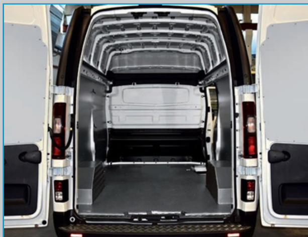
Suelo en multicapa de abedul marmoleado, panel en chapa barnizada gris, protector de rueda en acero aluminado y damero
