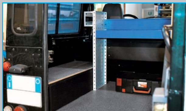
Equipamiento interno con estanterías y cajoneras montado en Land Rover Defender.
