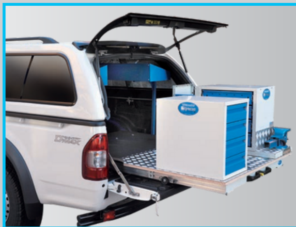
Montaje en corredera de los componentes sobre Pick Up.
